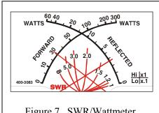
Figure 7. SWR/Wattmeter.
